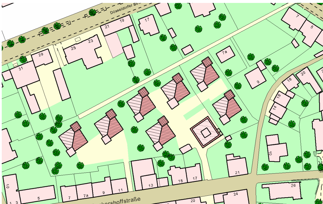
Denkbare Bebauung des Innenbereiches mit Punkthäusern
